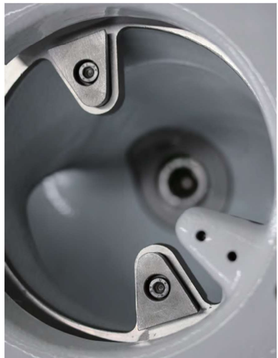
ASC切割系统拥有可替换的硬质合金刀片(HRC 55)
