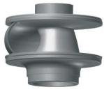
闭式单通道叶轮 Ø 80mm 球形间隙 1450rpm
